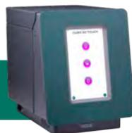
Strumento per la determinazione della VES in EDTA. Garantisce 30 risultati in 25 minuti con metodo Westergren modificato. Nessuna provetta dedicata, semplice e facile da usare, rispettoso dell'ambiente. Test eseguito su provette chiuse: nessun consumo del campione di sangue, nessun reagente richiesto, nessuna produzione di liquidi reflui, massima sicurezza e protezione dell'operatore.
